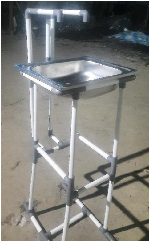
Gambar 3. Rangka alat cuci tangan
